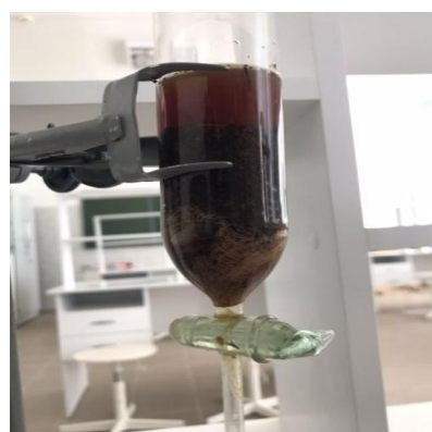
Рис.2 Перколятор заправленный корневищем с корнями валерианы
